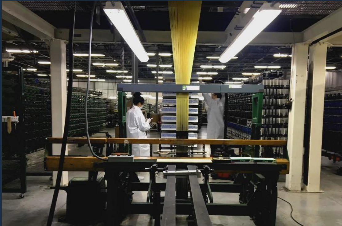
3D织机和压铸机：工业提花织机，用于3D织造，带有线架和线束细节。
