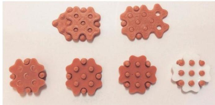
圖 59：試印測試接合參數以及高度測試，右下為 ABS 硬料與 TPU 軟料接合效果
